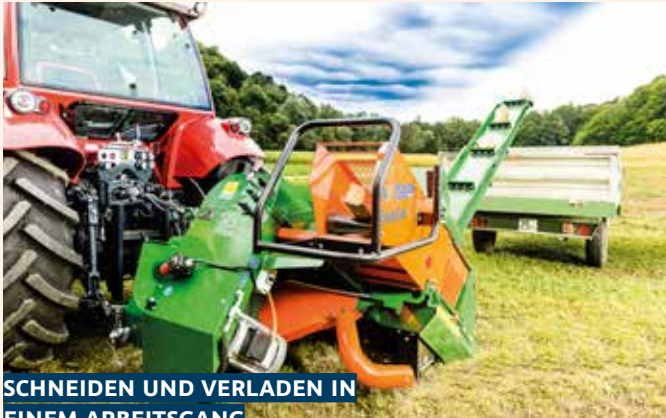
LEICHTGÄNGIGE BESCHICKUNG ÜBER DIE HOLZLADE
