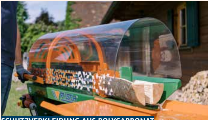
SCHUTZVERKLEIDUNG AUS POLYCARBONAT
